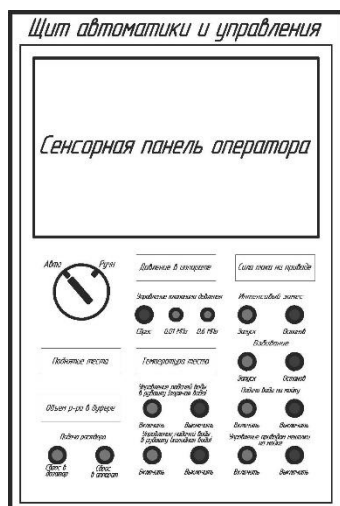
Рисунок 3 – Передняя панель щита управления и структура человеко-машинного интерфейса
