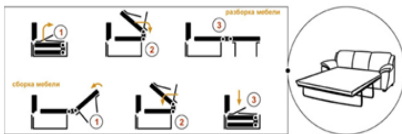
Рисунок 5 – Схема трансформации механизма «Седафлекс»
