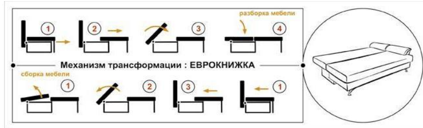
Рисунок 2 – Схема трансформации механизма «Еврокнижка»
