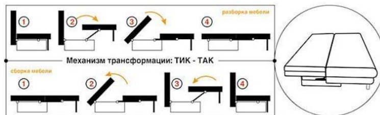
Рисунок 3 – Схема трансформации механизма «Тик-так»
