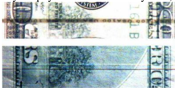
Рисунок 2 – Имитация нити с наклейкой бумажной полоски: а – на просвет; б – в УФЛ
