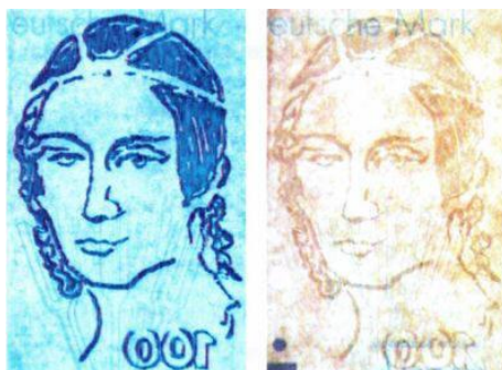
Рисунок 1 – Водяной знак, имитированный надпечаткой со штриховой формы: а – под ультрафиолетовыми лучами; б – на просвет
