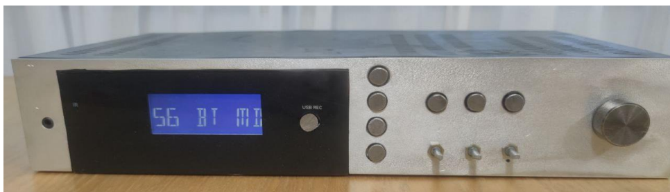
Рисунок 4 – Готовый усилитель звука с цифровым управлением
