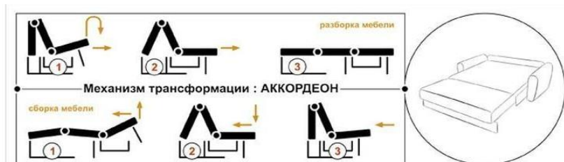
Рисунок 1 – Схема трансформации механизма «Аккордеон»
